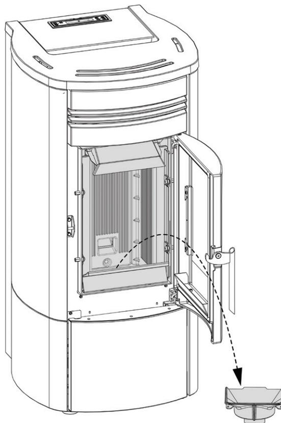
**UN BRACIERE PULITO GARANTISCE UN CORRETTO FUNZIONAMENTO! MANTENENDO IL BRACIERE E I SUOI FORI SEMPRE BEN PULITI DA EVENTUALI RESIDUI DI COMBUSTIONE, SI GARANTISCE AL GENERATORE UN'OTTIMA COMBUSTIONE NEL TEMPO, EVITANDO EVENTUALI MALFUNZIONAMENTI CHE POTREBBERO RICHIEDERE L'INTERVENTO DEL TECNICO. È POSSIBILE UTILIZZARE LA FUNZIONE NEL MENU UTENTE "EASY SETUP" PER ADEGUARE LA COMBUSTIONE IN BASE ALLE ESIGENZE DESCRITTE.**
