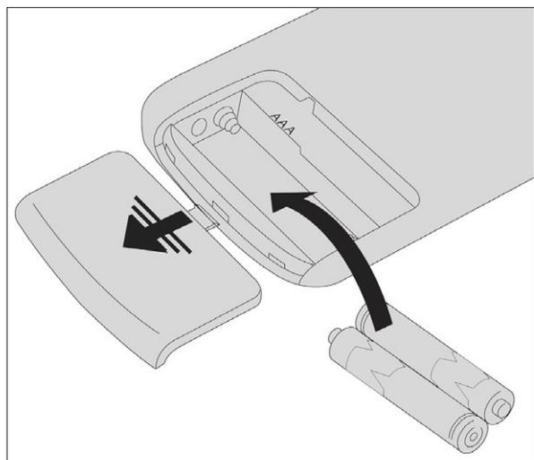
**SE IL TELECOMANDO È SPENTO PER ASSENZA DI BATTERIE, È POSSIBILE COMANDARE LA STUFA DAL PANNELLO COMANDI, POSTO NELLA PARTE SUPERIORE DELLA STUFA. DURANTE L'OPERAZIONE DI SOSTITUZIONE PRESTARE ATTENZIONE ALLA POLARITÀ SEGUENDO LA SIMBOLOGIA IMPRESSA SUL VANO INTERNO DEL TELECOMANDO.**
