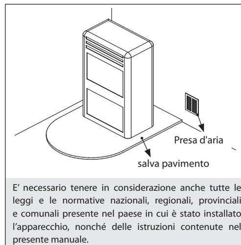
In presenza di apparecchi a gas di tipo B a funzionamento intermittente non destinati al riscaldamento deve essere ad essi dedicata un'apertura di aerazione e/o ventilazione.
