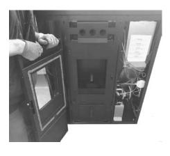
Fig. 45 - Remove the door
