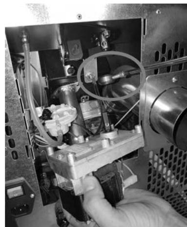
*Fig. 80 - Rimozione motoriduttore*
