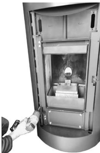
*Fig. 65 - Rimozione viti profili (dx e sx).*
