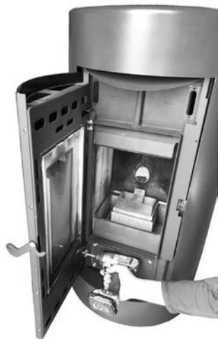
*Fig. 64 - Rimozione porta*
