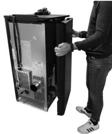
**Fig. 49 - Rimozione fianco**
