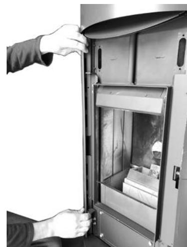
*Fig. 66 - Rimozione profili anteriori (dx e sx).*
