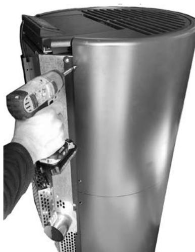
*Fig. 67 - Rimozione viti posteriori*
