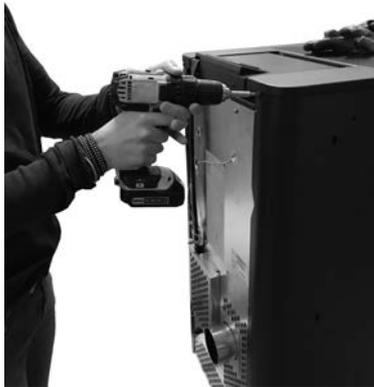
**Fig. 48 - Rimozione viti**
