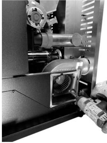
**Fig. 62 - Remove fan screws**
