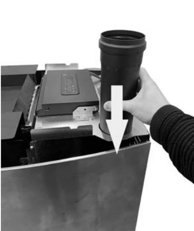
**Fig. 64 - Insert pipe**
